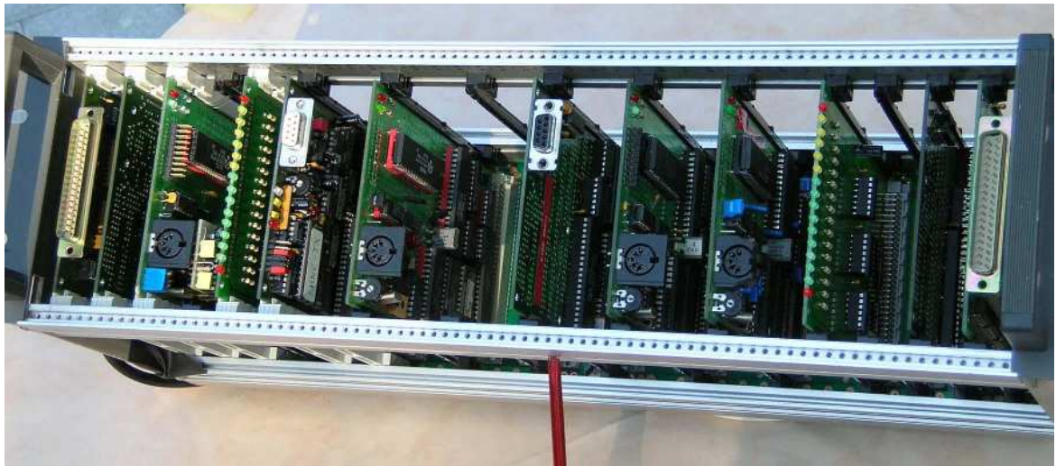
Knoten in zweifacher Ausführung eingebaut in 19“-Test-Rack Vergrößerung vom Testknoten 1, von links nach rechts: Resetkarte – Solomaster – Userkarte – Bus-Monitor – Kanalrechner FSK – Kanalrechner AFSK
